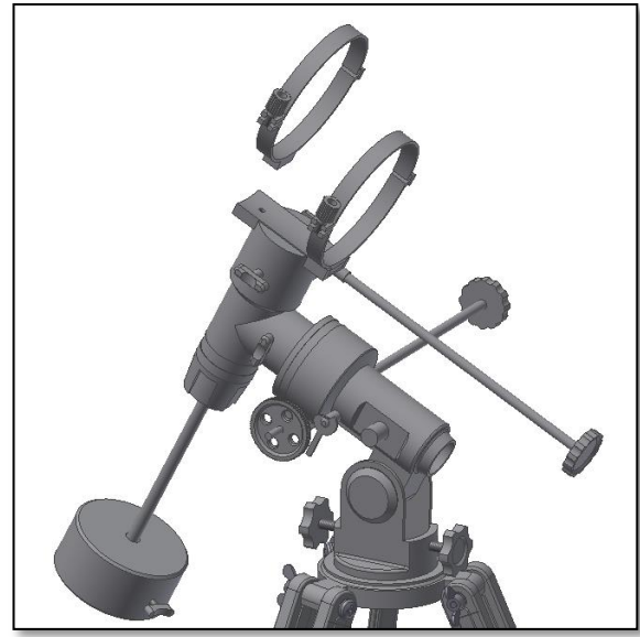
Abb. 5. Anbringung und Festziehen der Rohrschellen.
